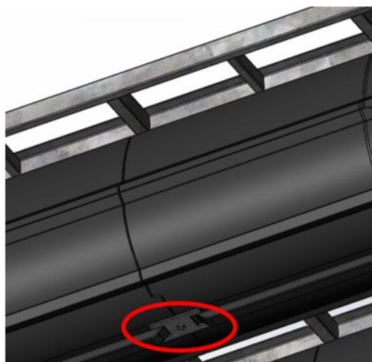
Połączenie platformy z pływakiem typu W1200/W800 Połączenie platformy z pływakiem typu W1200 S
