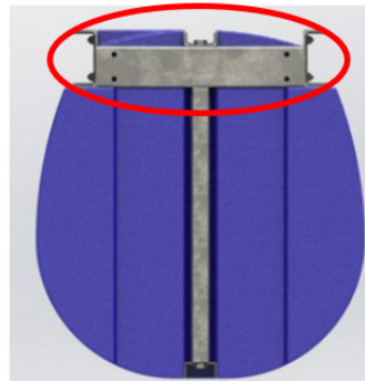
Rysunek: łączenie pływaków W1200 środkowych, widok z góry Rysunek: łączenie pływaków W800, widok z tyłu
